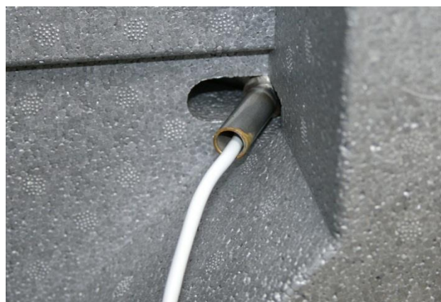
Abbildung 15: Temperaturfühler bis zum Anschlag eingeschoben
